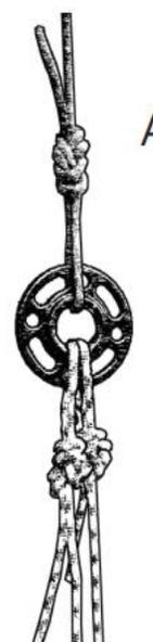
**Figura 3.** Doble estacionaria: Cuerdas dobles ancladas utilizando nudos en ocho trazados en una instalación de cuerda estacionaria.
