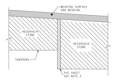
MEMBRANE/GEOTEXTILE CHECK DAM
